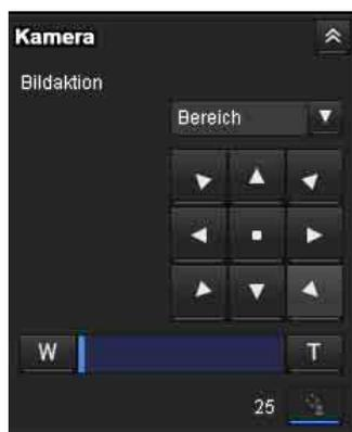
Das Bedienfeld der Kamera erscheint, wenn SolidPTZ auf **Ein** gesetzt ist. Über diesen Bereich können Sie die Schwenk-/Neige-/Ausgangsposition der Kamera und den Zoom steuern (Seite 25). Darüber hinaus können Sie die Berechtigung zur Kamerabedienung im Exklusivbedienmodus erhalten.
